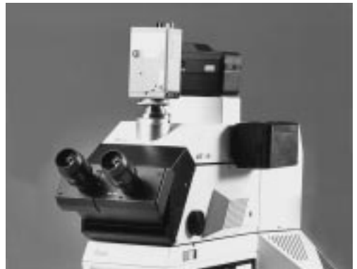
Fig. 33 Leica DM RD HC phototube
